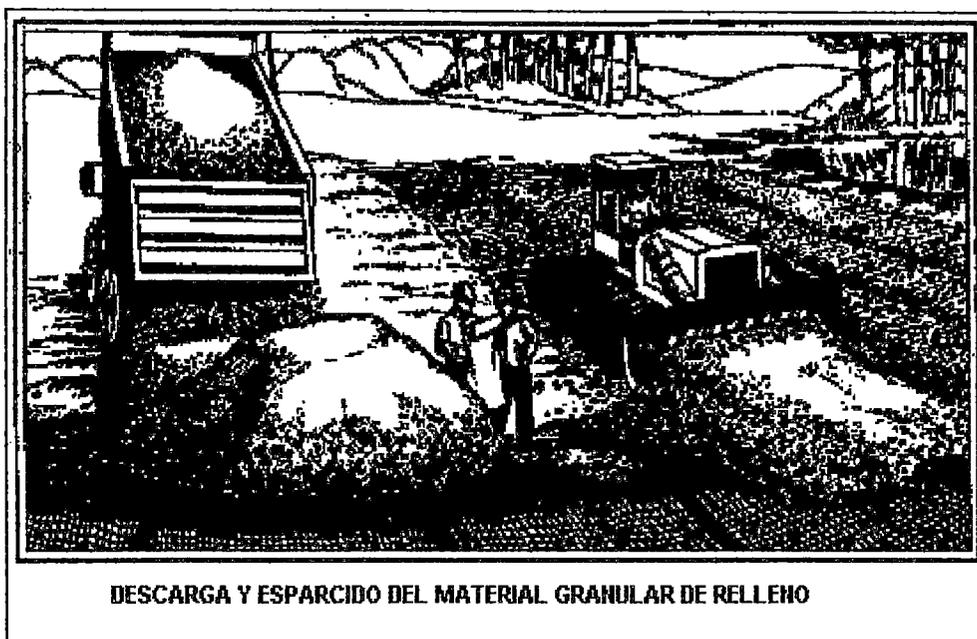
Una vez que se tiene un área sobre la cual se tenga una primera capa de material de firme extendida (puede ser sobre la geomalla, dependiendo si esta es su ubicación dentro del pavimento), se vacía la siguiente tanda de material; sobre el firme ya colocado. Luego empujar el material de firme sobre la geomalla con un tractor o una motoniveladora.
