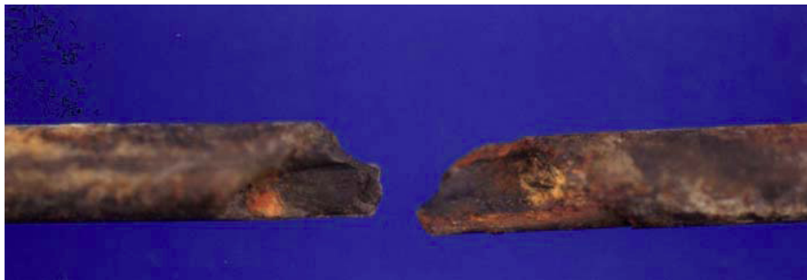
FIGURA 22. ROTURA FRÁGIL DE LOS ALAMBRES DE ACERO POR EXPOSICIÓN AL HIDRÓGENO
