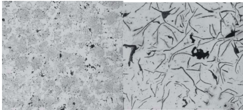
FIGURA 30. FUNDICIÓN GRIS CON TRAZAS DE GRAFITO (PARTE IZQDA) Y GRAFITO AGRUPADO CON FORMA DE RED (PARTE DERECHA).
