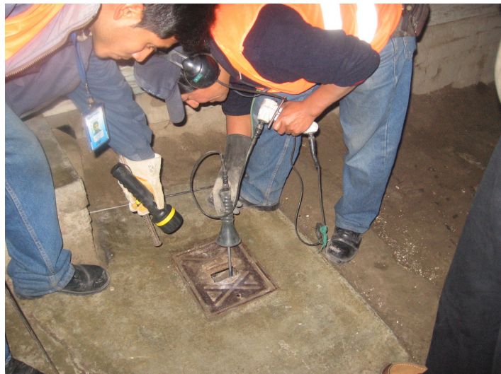
FIGURA 85. VARILLA DE ESCUCHA PARA LA DETECCIÓN DE FUGAS EN CONEXIÓN
