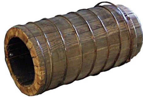
FIGURA 7. TUBERÍA DE MADERA INSTALADA EN HAMILTON, ONTARIO (RAJANI, 2009A).
