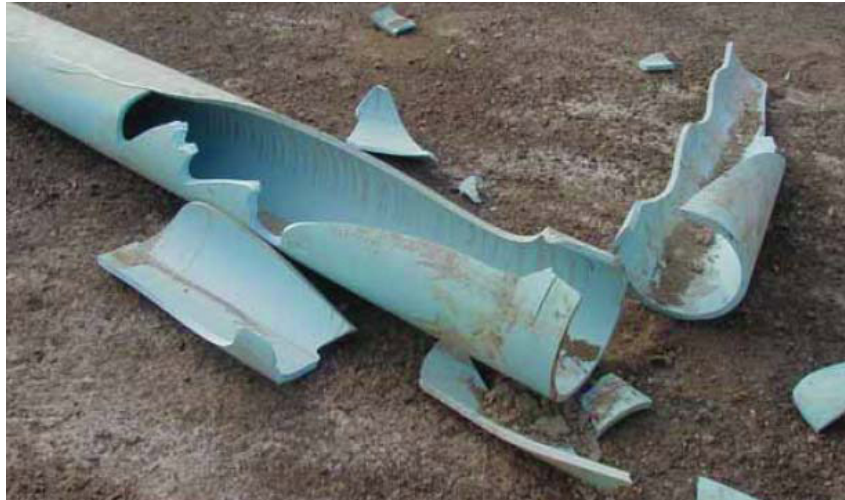
FIGURA25. ROTURA LONGITUDINAL DE UNA TUBERÍA DE 300 MM DE PVC.(RAJANI, 2009C)
