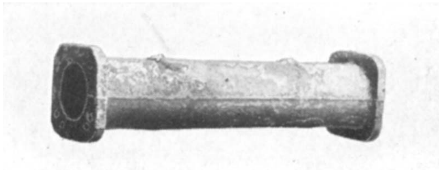
FIGURA 9. TUBERÍA DE FUNDICIÓN GRIS QUE SIRVE PARA TRAER AGUA HASTA LOS JARDINES DE VERSALLES. TODAVÍA EN SERVICIO EN EL AÑO 1914
