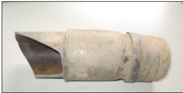
FIGURA 63. TUBERÍA DE PVC "ITINTEC": TUBERÍA PVC CON PEGAMENTO CON UNA ESTRUCTURA RÍGIDA
