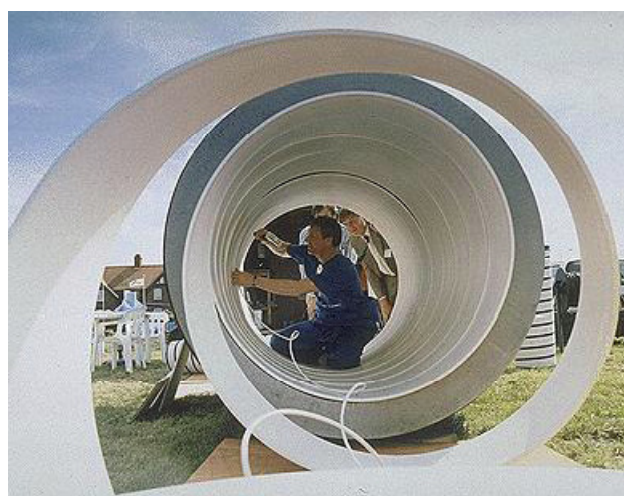
FIGURA G.29. LÁMINA DE PVC CORTADA HELICOIDALMENTE.
