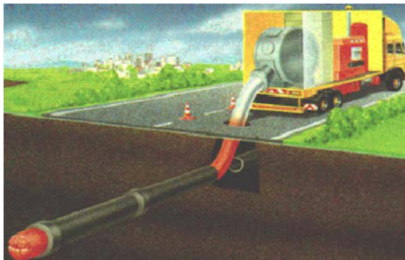
FIGURA G.27. REHABILITACIÓN DE UNA TUBERÍA MEDIANTE ENCAMISADO TÉRMICO
