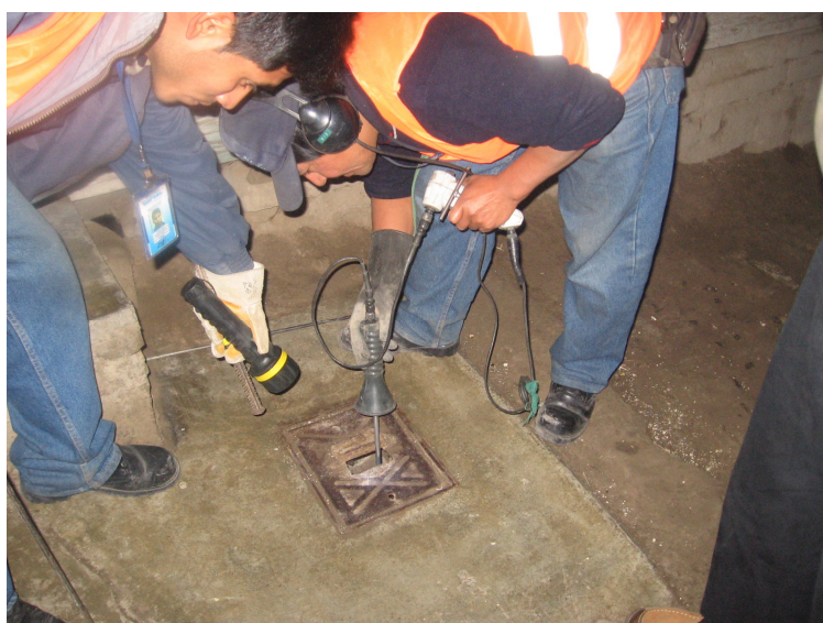
FIGURA D.9. VARILLA DE ESCUCHA PARA LA DETECCIÓN DE FUGAS EN CONEXIÓN
