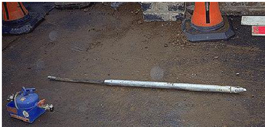
FIGURA G.42. CILINDRO METÁLICO QUE SE INSERTA EN EL TERRENO
