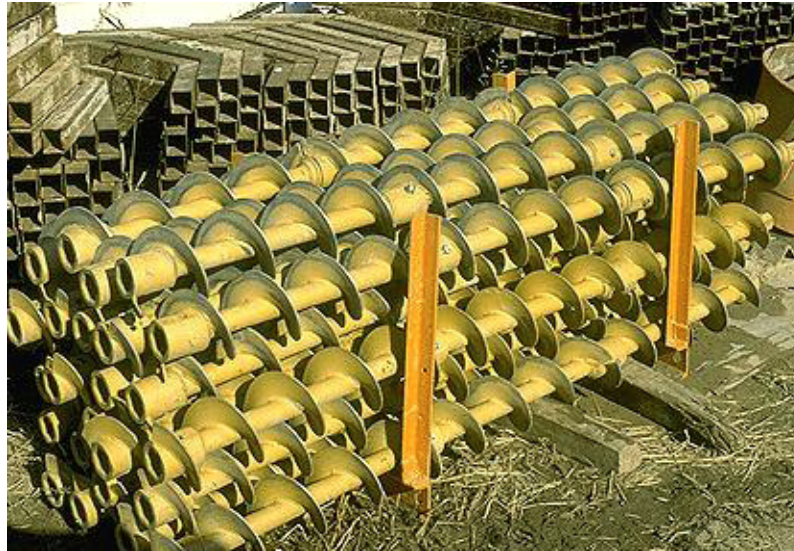
FIGURA G. 47. VARILLAS EMPLEADAS EN LA TÉCNICA INSERCIÓN DE TUBERÍA MEDIANTE EL TALADRO CON TORNILLO SIN FIN
