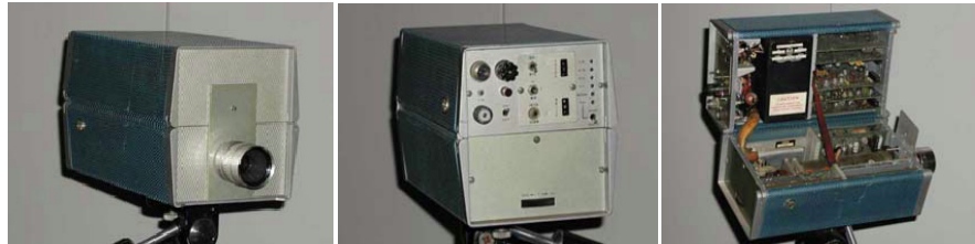
FIGURA G. 6. CÁMARAS CON TUBO DE VIDICON DE LOS AÑOS 50 FABRICADAS POR RCA CORPORATION.
