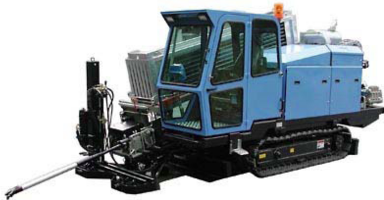
FIGURA G.41. MÁQUINA UTILIZADA PARA LA PERFORACIÓN HORIZONTAL DIRIGIDA
