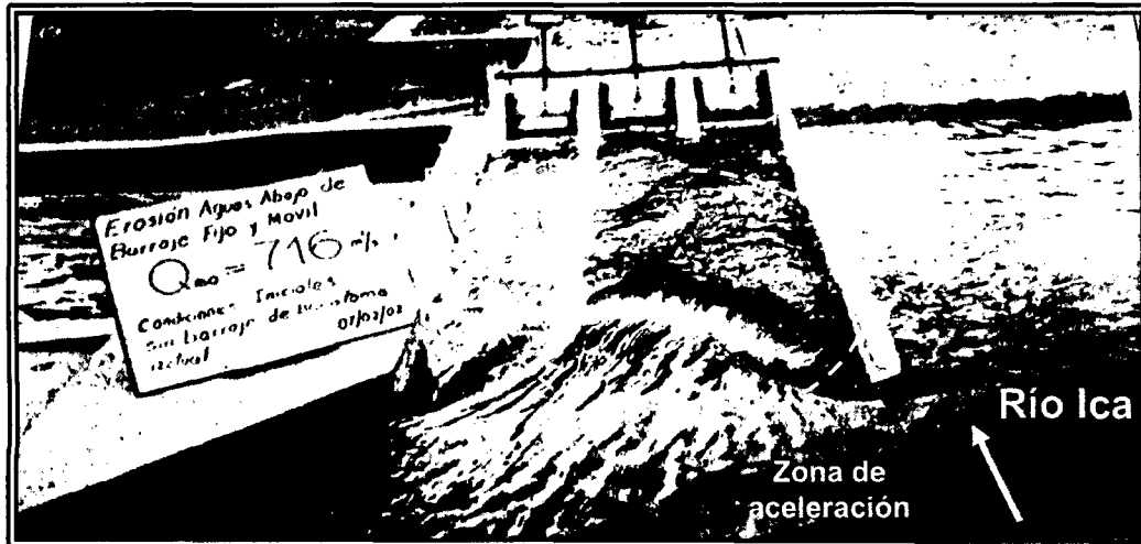
Figura 2.11. Zona de aceleración en el canal de aproximación al barraje móvil. Modelo La Achirana.
