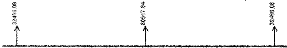
Figura Nro. 03.12 - Reacciones - viga principal
