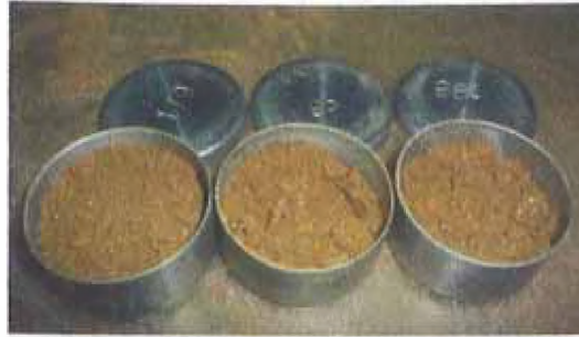
Figura 5.5 - Cápsulas con mezclas suelo-ceniza retirados del moldeado.
