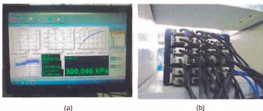
Figura 5.2 - Hardware y software utilizados para el ensayo triaxial. (a) Software CatmanEasy en la etapa de corte, (b) Sistema de adquisición de datos.
