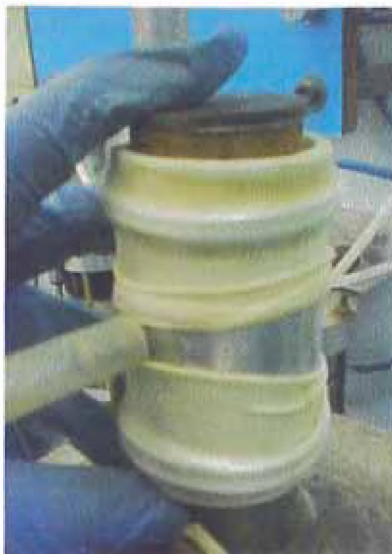
Figura 5.10 - Colocación del papel filtro e la piedra porosa en la parte superior del cuerpo de prueba.
