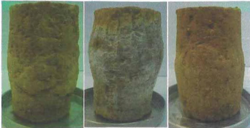
(a) (b) (c) Figura 6.13 – Muestras de S60CV40 T30d - (a) Muestra a 50 kPa; (b) Muestra a 200 kPa; (c) Muestra a 400 kPa.
