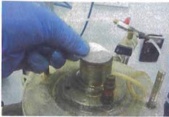
Figura 5.8 - Colocación del papel filtro.
