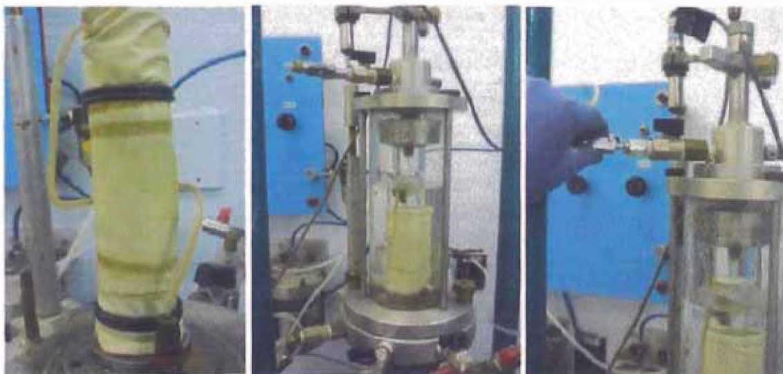
(a) (b) (c) Figura 5.11 – Cuerpo de prueba antes del inicio del ensayo triaxial. (a) Fijado de la membrana con los anillos de jebe; (b) Llenado de la cámara triaxial con agua (c) Colocación de la conexión de presión confinante.
