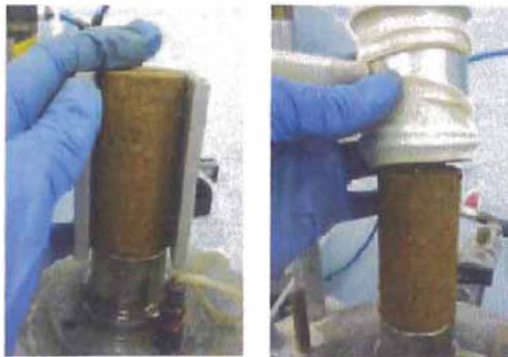
(a) (b) Figura 5.9 – Colocación de cuerpo de prueba. (a) Colocación del cuerpo de prueba en la prensa triaxial; (b) Colocación de la membrana con ayuda de un molde de acero.
