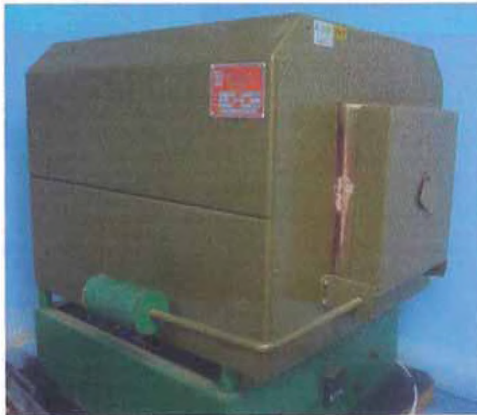
Figura 4.5 - Horno de 440 °C usada para las mezclas suelo-ceniza del Laboratorio de Geotecnia y Medio Ambiente de la PUC-Rio.
