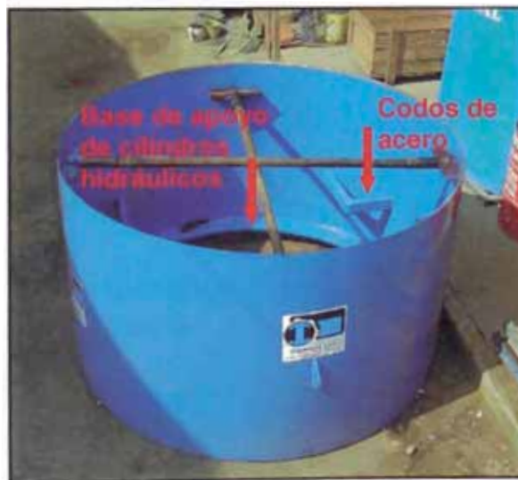
Fotografía 6.29: Tubo perdido o anillo metálico
