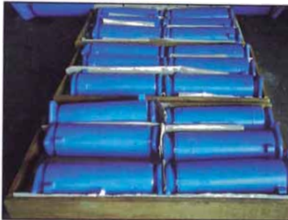
Fotografía 6.30: Cilindros hidráulicos de Estación Intermedia
