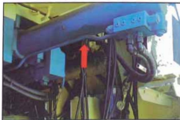
Fotografía 6.16: Cilindro de Avance del Carro
