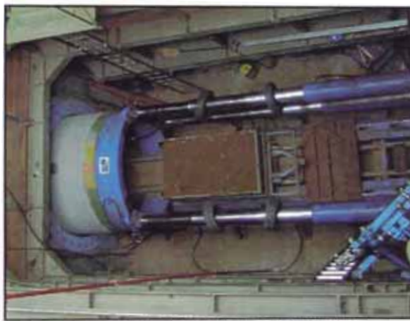
Fotografía 6.24: Cilindros de Empuje
