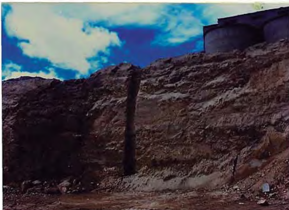
Foto. 2.4... PARTE DE UNA TRINCHERA TERMINADA Y LISTA PARA EL MUESTREO ( Jun., 1987 )
