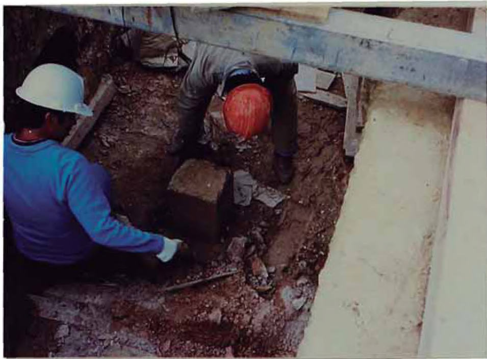
Foto. 3.3.- ESPECIMEN TALLADO LISTO PARA MONTAR LA CAJA METALICA DE CONFINAMIENTO. (Jun., 1988)
