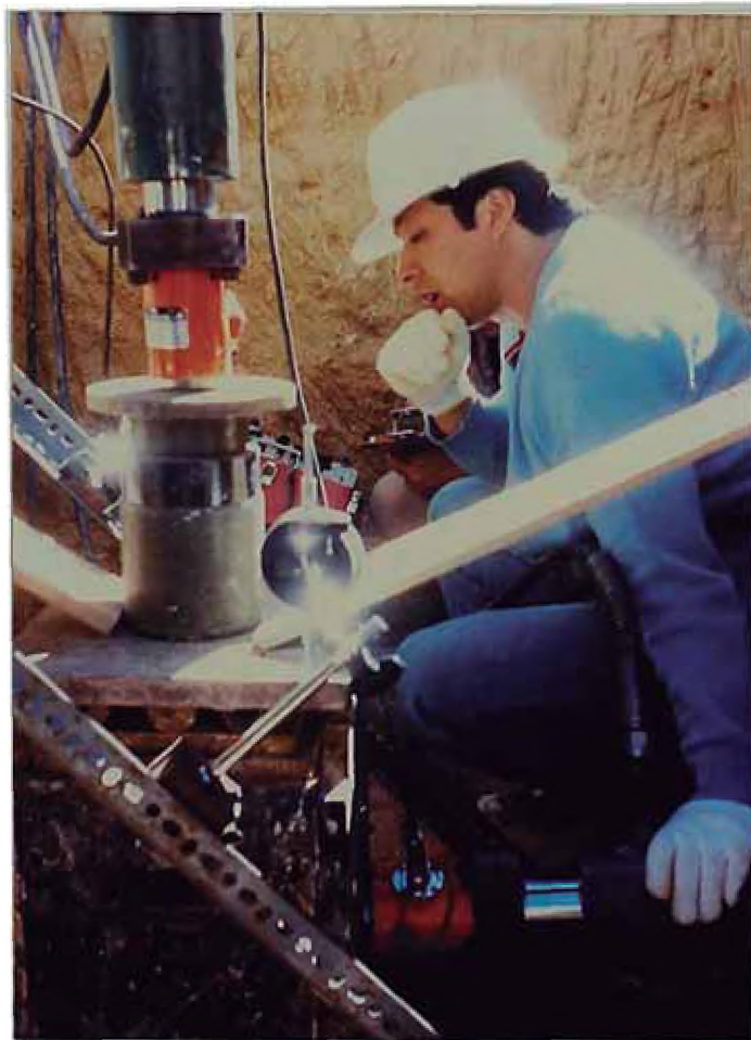
Foto 3.4.- APLICACION DE CARGAS VERTICAL Y HORIZONTAL MEDIANTE GATO HIDRAULICO. (Jun., 1988)
