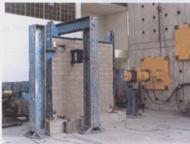
Figura 23: Montaje del equipo para el ensayo de MASR
