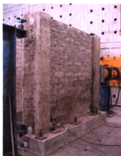
Figura 28: Montaje de equipo para ensayo de MAR
