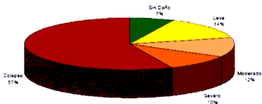
Figura 1: Niveles de Daño en Edificaciones de Adobe - Distrito de Chincha Baja
