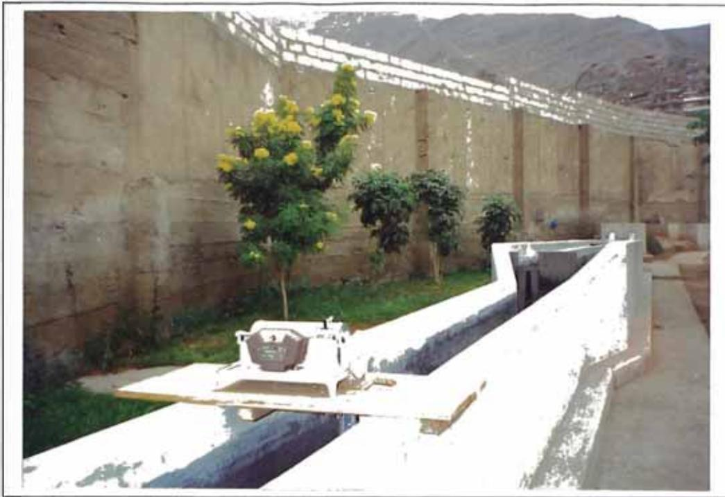
**Ilustración 5: Limnógrafo instalado para la medición continua del nivel de agua en el canal**
