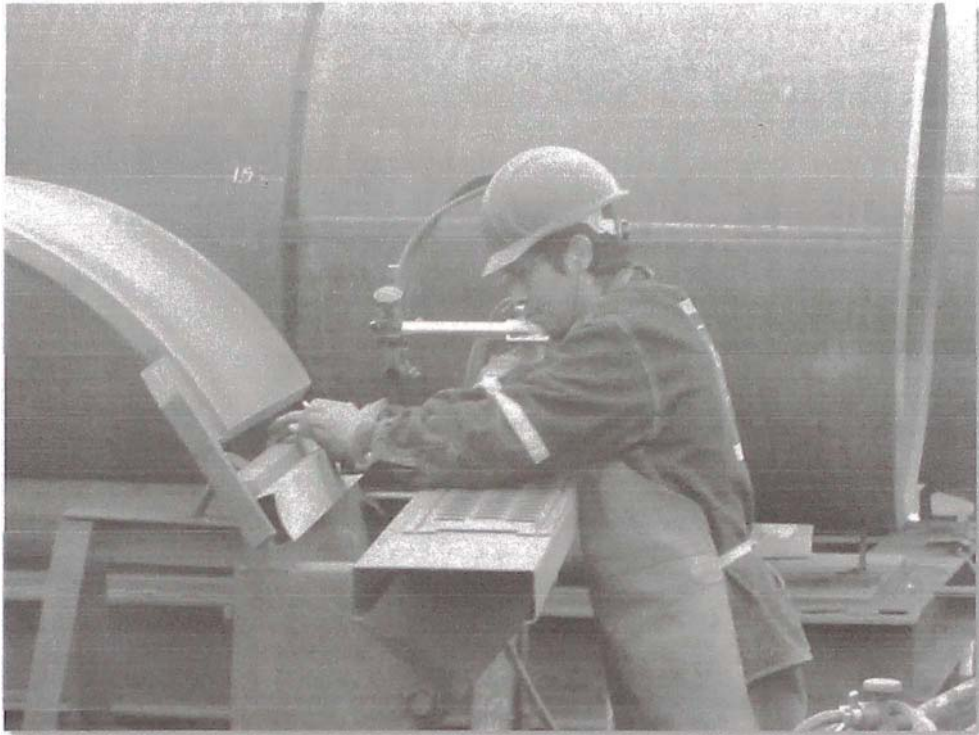
Figura 4.4: Preparación el soporte para el equipo de corte semiautomático.
