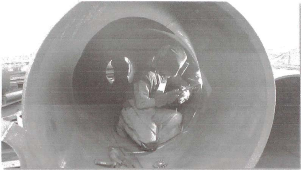
Figura 4.12: Soldadura interior circunferencial
