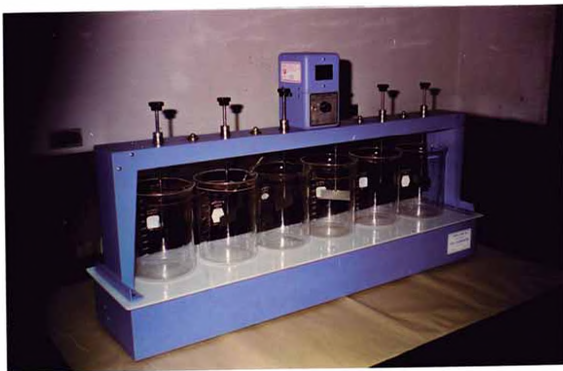
Figura N° 6-1 EL EQUIPO DE PRUEBA DE JARRAS
