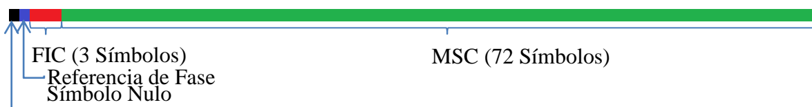
Figura 5.2 Estructura de la trama DAB considerando solo un tono utilizado
