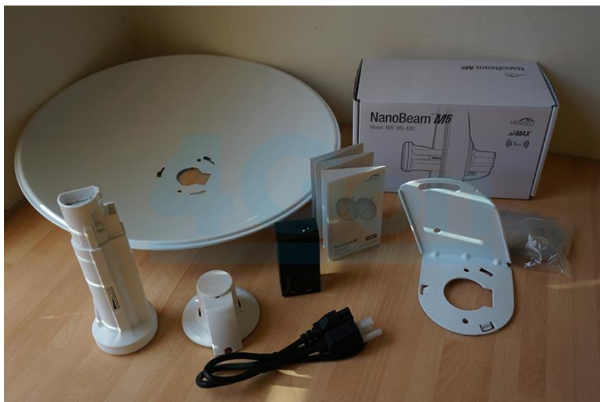
Fig. A.4 Detalle de los Componentes del Radio Enlace Ubiquiti NanoBeam M5.
