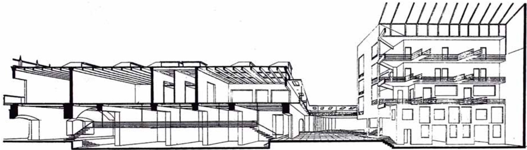
Corte fugado mostrando la galería del primer piso, los talleres en el segundo piso y el bloque nuevo en la zona posterior
