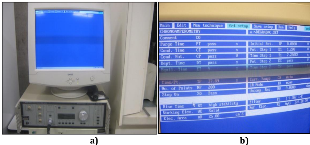
Figura 3.7: a) Potentiostato/Galvanostato EG&G Princeton Applied Research Model 263 y b) programación del metodo de cronoamperometria.
