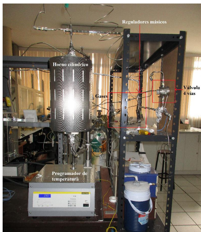
Figura 2.4. Sistema de reacción para la deshidrogenación oxidativa del etano con los equipos en el laboratorio de Fisicoquímica-Facultad de Ciencias-UNI.
