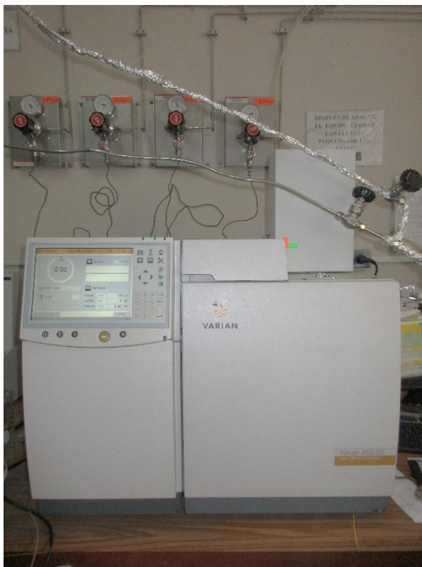
Figura 2.5. Cromatógrafo de gases GC-VARIAN-450. Ubicado en el Laboratorio de Investigación de Fisicoquímica de la Facultad de Ciencias-UNI.
