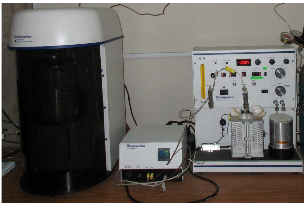
Figura 2.2. Equipo de sorción de N_2 (izquierda) y el equipo de TPR- H_2 y TPD- NH_3 (derecha).
