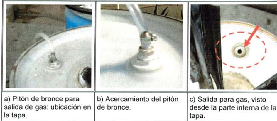
Figura 4.8: Vista del sistema de extracción de biogás.
