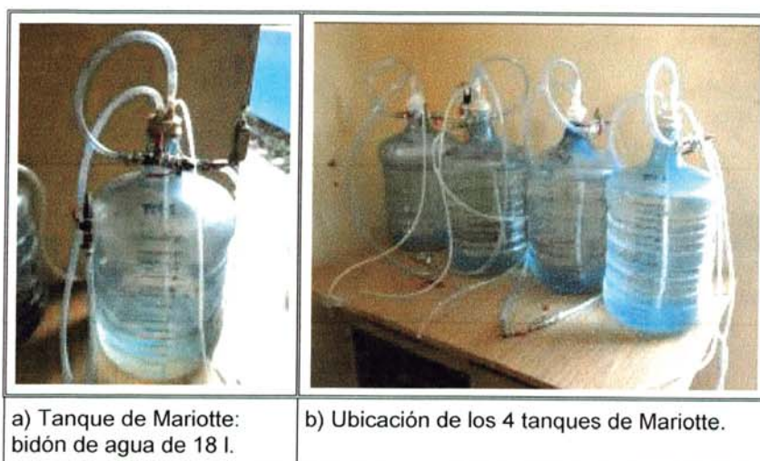
Figura 4.11: Vista de los gasómetros (tanques de Mariotte).
