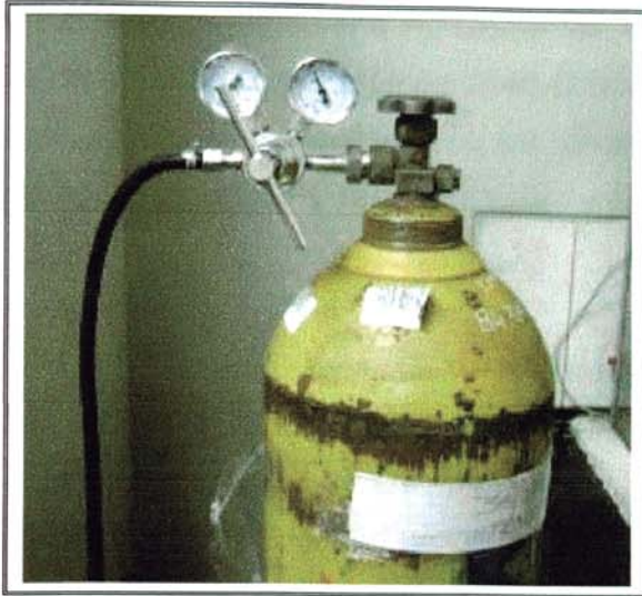
Figura 4.15: Vista del balón de Nitrógeno.
