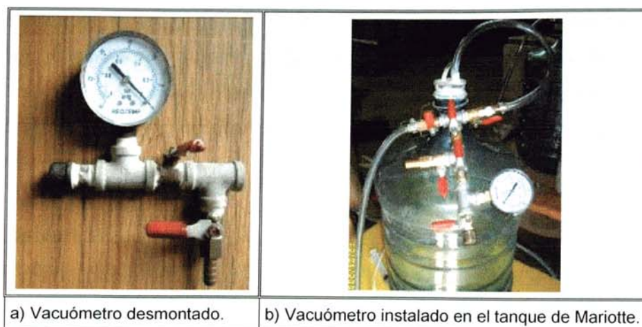
Figura 4.13: Vista del vacuómetro.
