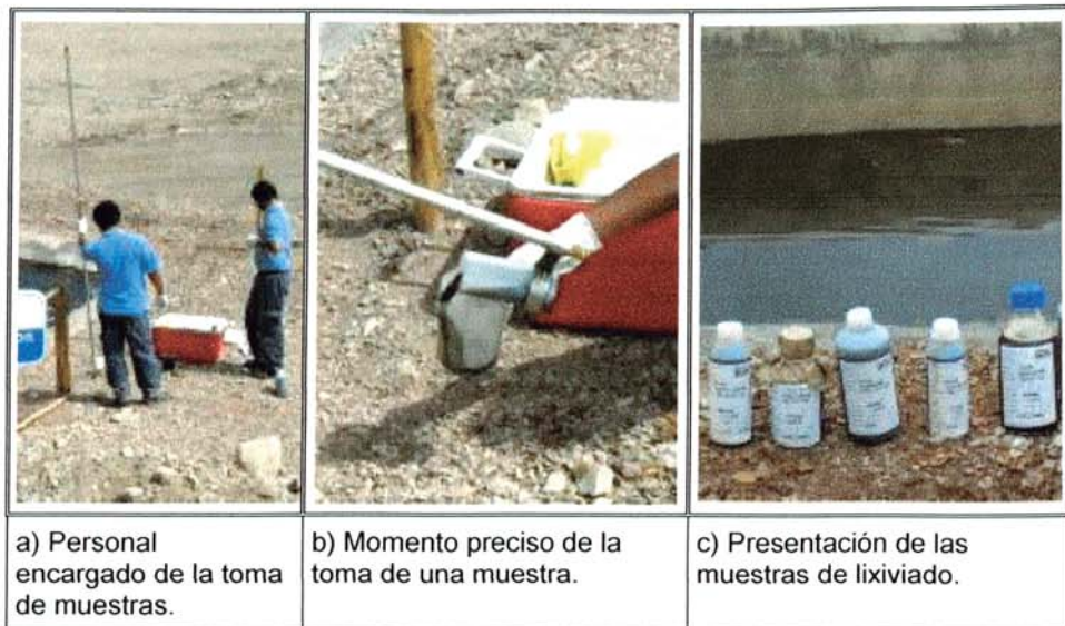
Figura 2.24: Vista del muestreo de lixiviados del relleno sanitario Portillo Grande, realizados por la consultora Cinyde SAC, en Junio del 2007.
