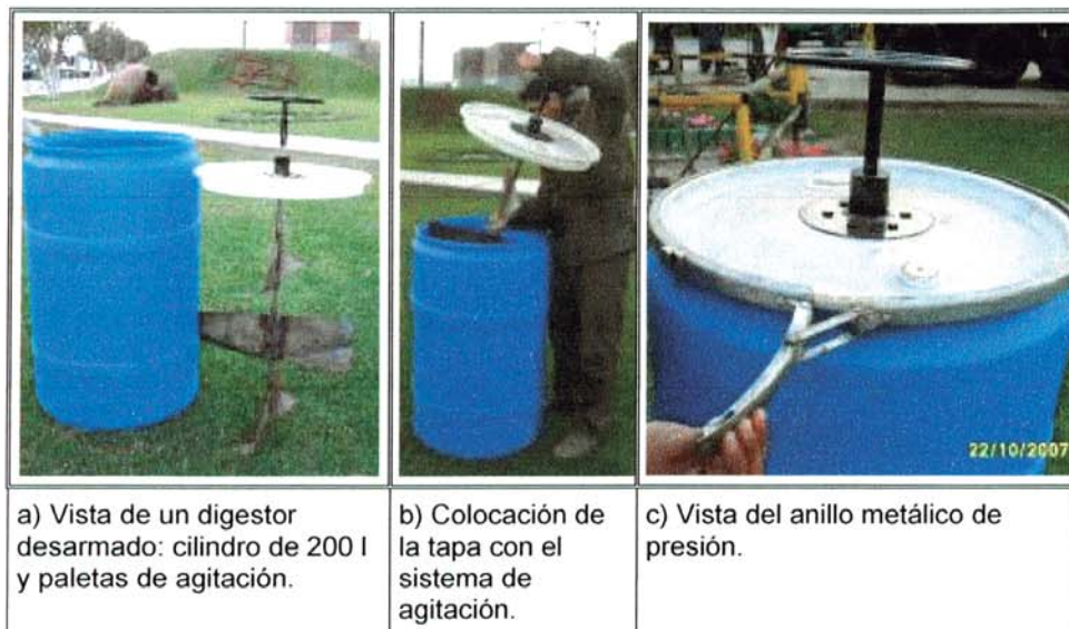
Figura 4.2: Cilindro de 200 l empleado como digestor Batch.
