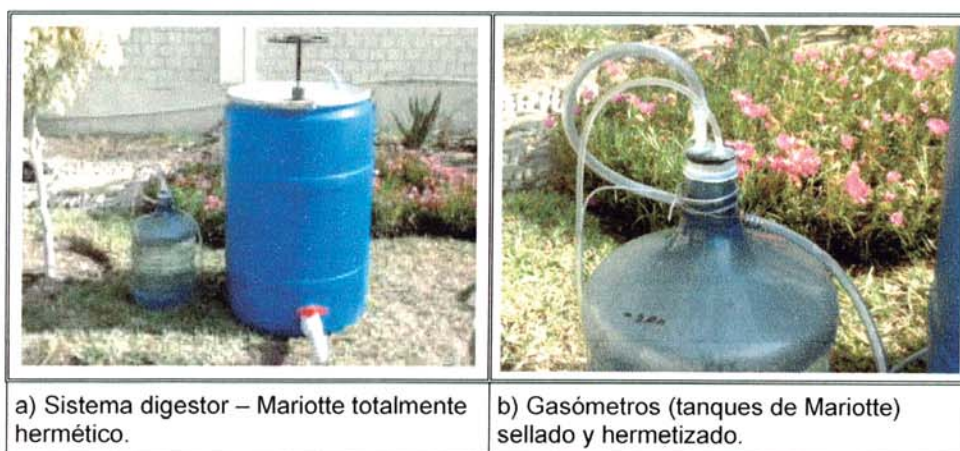
Figura 4.21: Vista del sistema Digestor –Mariotte hermetizado. Pta. De Transferencia de San Juan de Miraflores (23-12-07).
