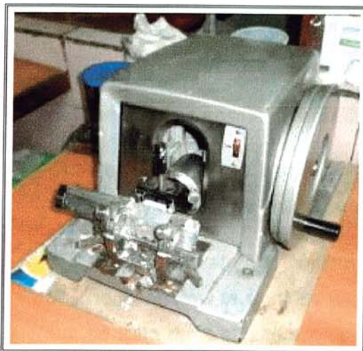
Figura 4.51: Vista del micrótopo empleado (De rotación, tipo Minot, marca American Optical).
