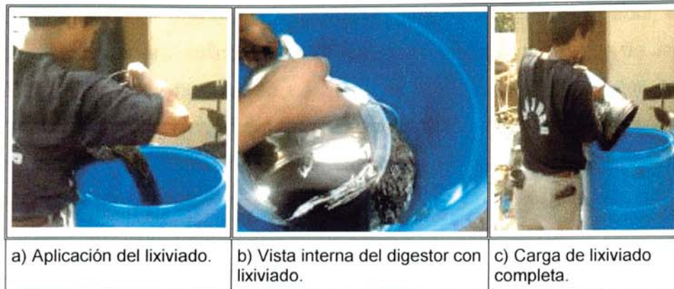
Figura 4.23: Llenado del digestor con lixiviado.
