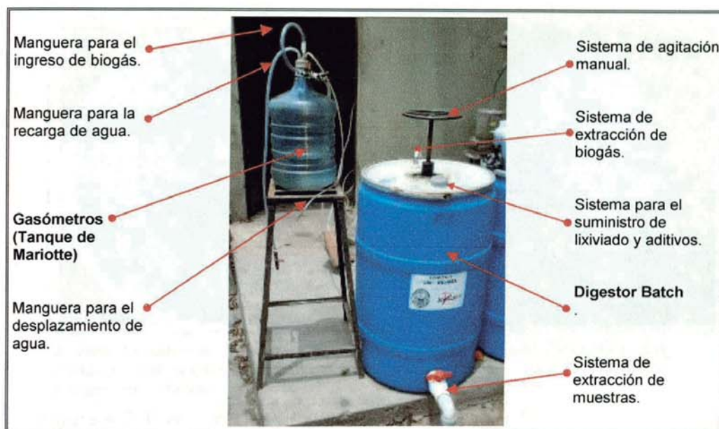
Figura 4.1: Vista panorámica del sistema "Digestor-Tanque de Mariotte".
