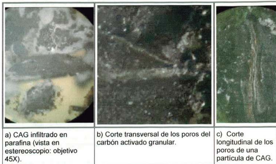
Figura 5.69: Vista de los poros de un grano de carbón activado infiltrado en parafina, a través de un estereoscopio.
