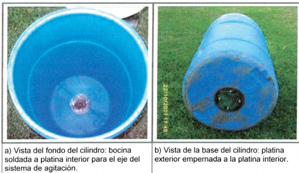
Figura 4.3: Base interior y exterior del cilindro de 200 l.
