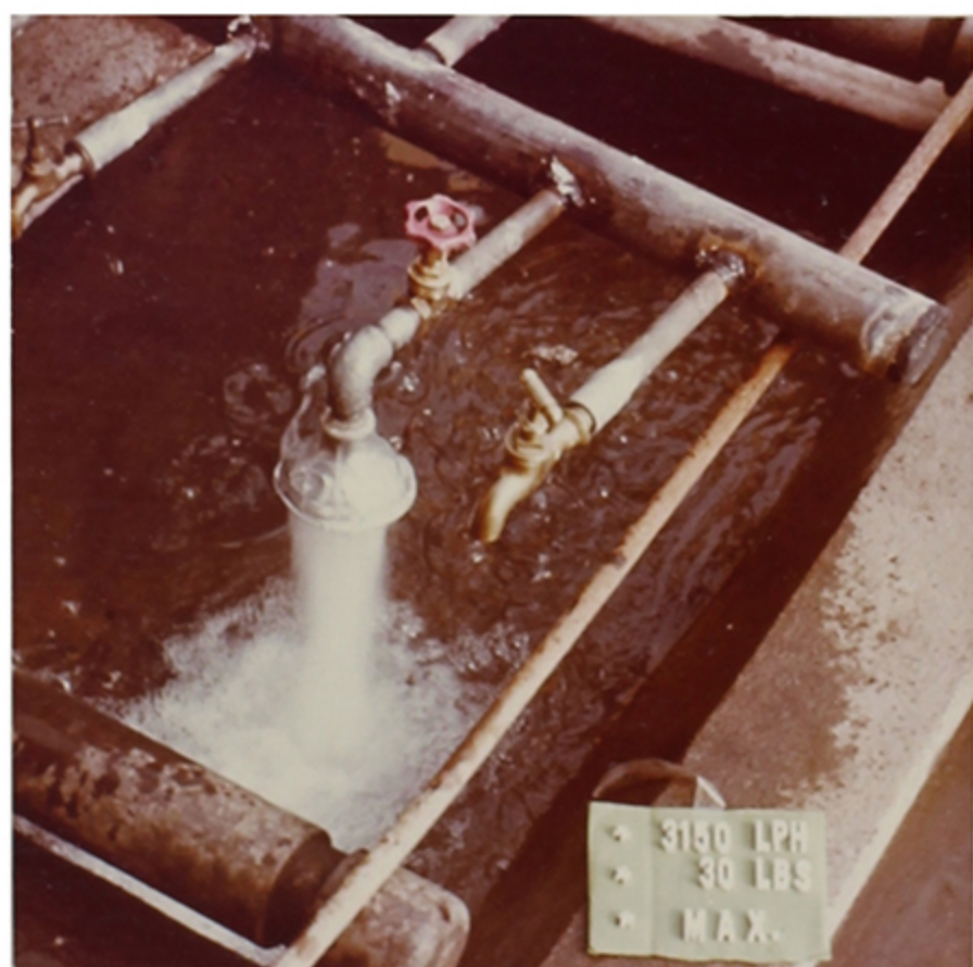
(c).- Salida de agua inmediata al medidor, presión de entrada 30 lbs/pg 2 . y 100% abertura de ducha.
