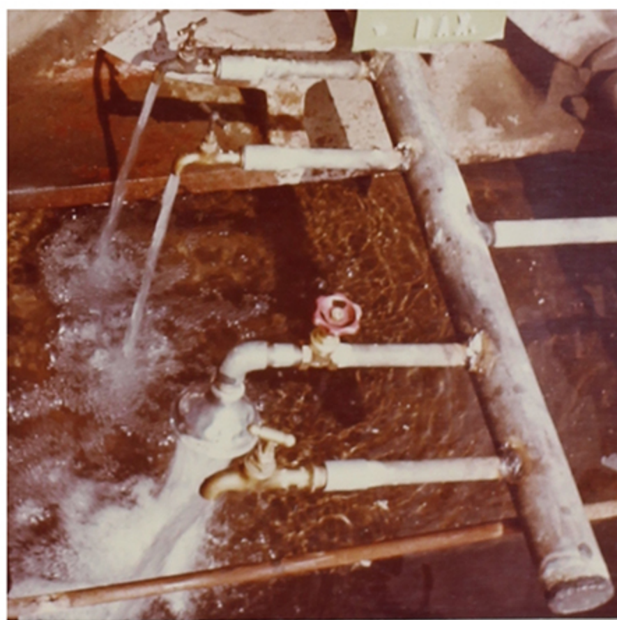
(d).- Salidas de agua inmediatas al medidor, presión de entrada 25 lbs, pg 2 . y 100% abertura; gasto: 3580 lts/hr.
