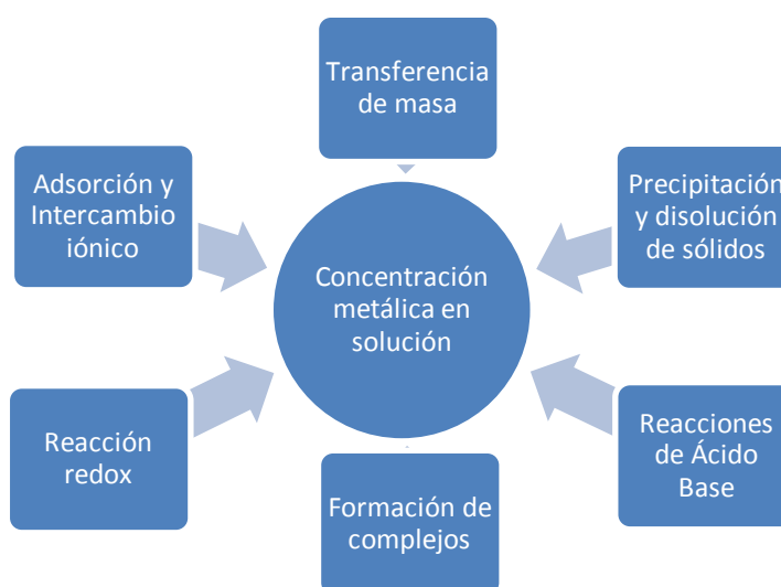
Figura 6.15: Procesos que generan concentración metálica en solución (Modificado de Mattigod, et al., 1981)
