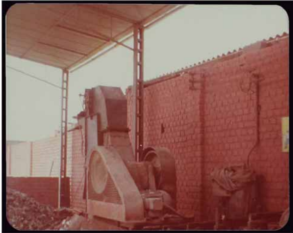
Foto N°3... Se observa una máquina vibradora con su faja transportadora, el trabajador que la operaba seleccionando el vidrio no usaba equipo
