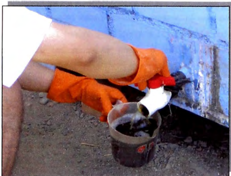
Foto N° 4.7.5: Recolección del lixiviado generado en la Celda Piloto.
