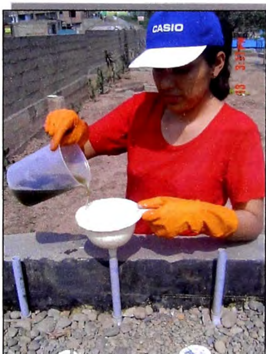
Foto N° 4.7.6: Recirculación manual de los lixiviados en las celdas a través de las tuberías de distribución.
