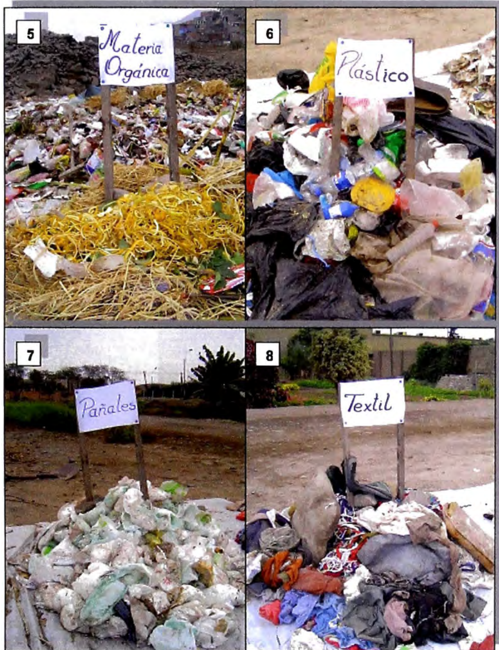
Foto N° 4.6.5: Materiales segregados: 5. Materia Orgánica: 29% 6. Plásticos: 12% 7. Pañales: 3% 8. Trapos: 3%
