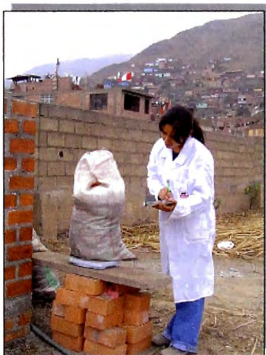
Foto N° 4.6.6: Pesaje de las fracciones segregadas previo a su disposición en las Celdas piloto.
