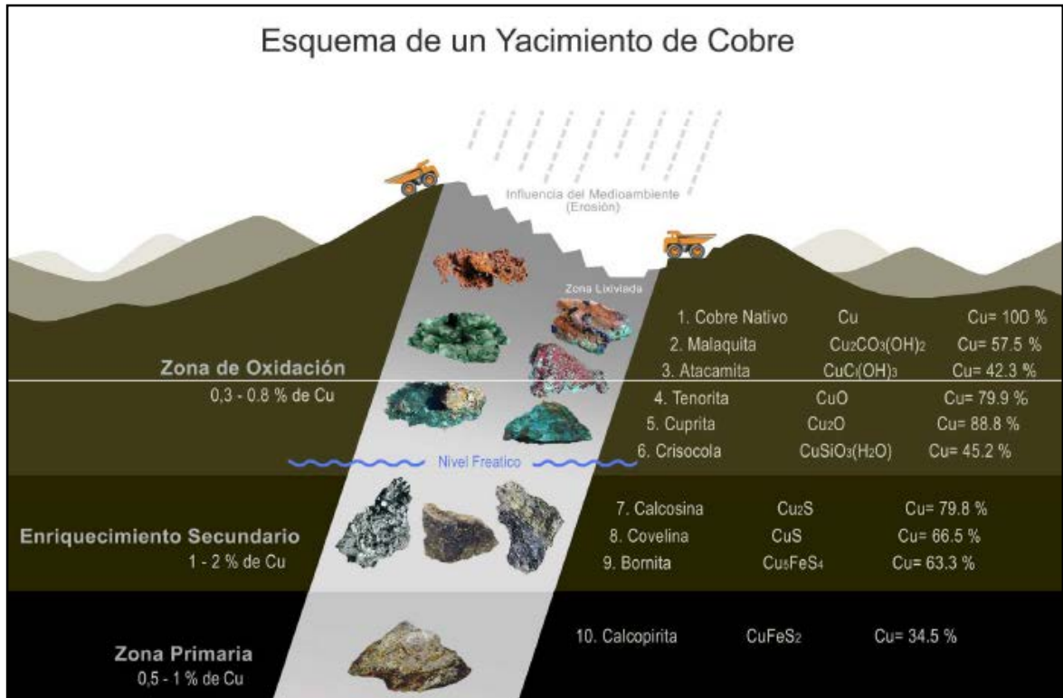
Figura 2.3 Esquema de un yacimiento de cobre
