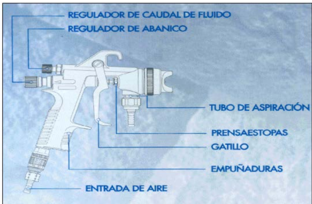
Figura 2.3: Esquema de una pistola aerográfica. Elementos
