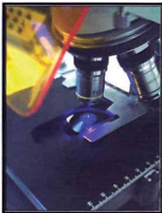
Foto 25: Se puede observar la luz emitida por el microscopio utilizado en la técnica de epifluorescencia.
