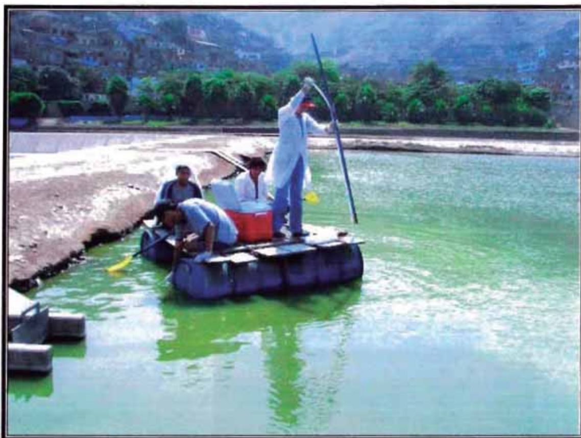
Foto 41: Vista de toma de muestras a una profundidad de 1,30 m
