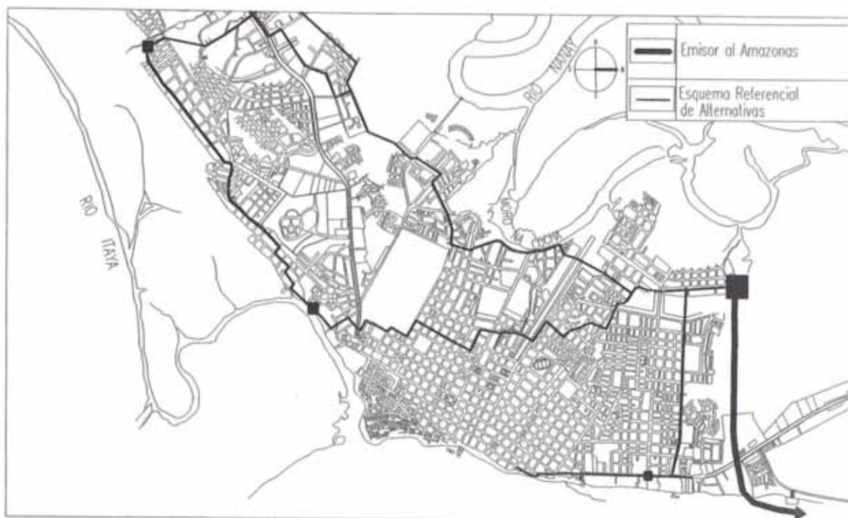
Figura 40 : Bombeo de Aguas Tratadas Mecánicamente Hacia el río Amazonas
