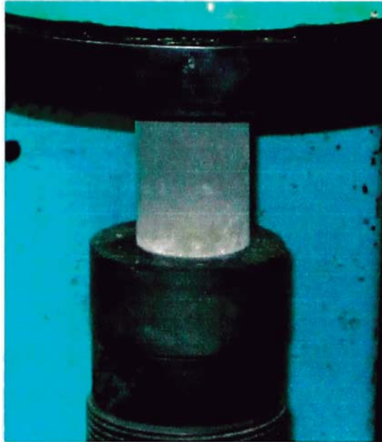
Pequeña "Probeta" lista a ser ensayada, alineada al eje con la prensa, que comprime con una velocidad controlada
