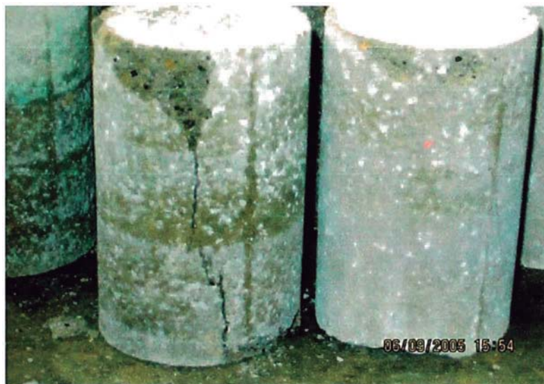
Así quedaron las "próbetas" luego del ensayo realizado el 06/09/05 como puede apreciarse en la fotografía
