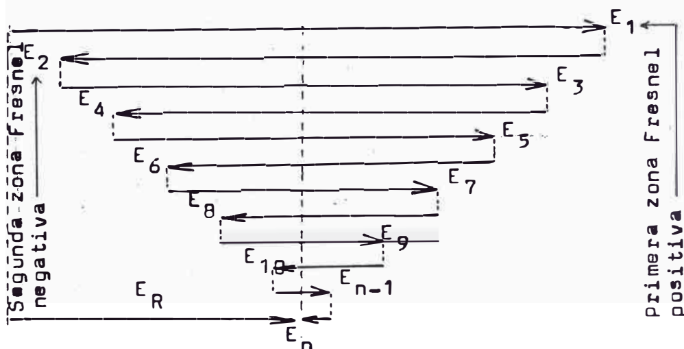
Figura 3.13 : Campo total E_R descompuesto según Fresnel
