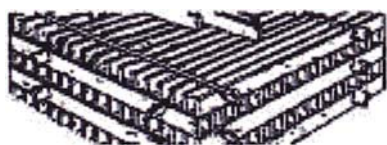
TABLILLAS DE MADERA colocadas en capas perpendiculares, que exponen bordes estrechos al aire ascendente y superficies laterales anchas cubiertas de una película de agua.
