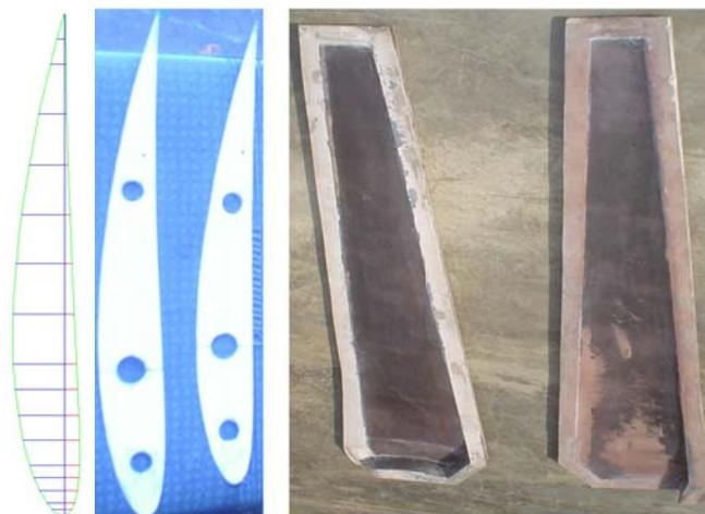
**Figura 5.7** Forma del perfil de una sección del alabe, dos plantillas de perfiles y moldes de los intrados y extrados del alabe.
