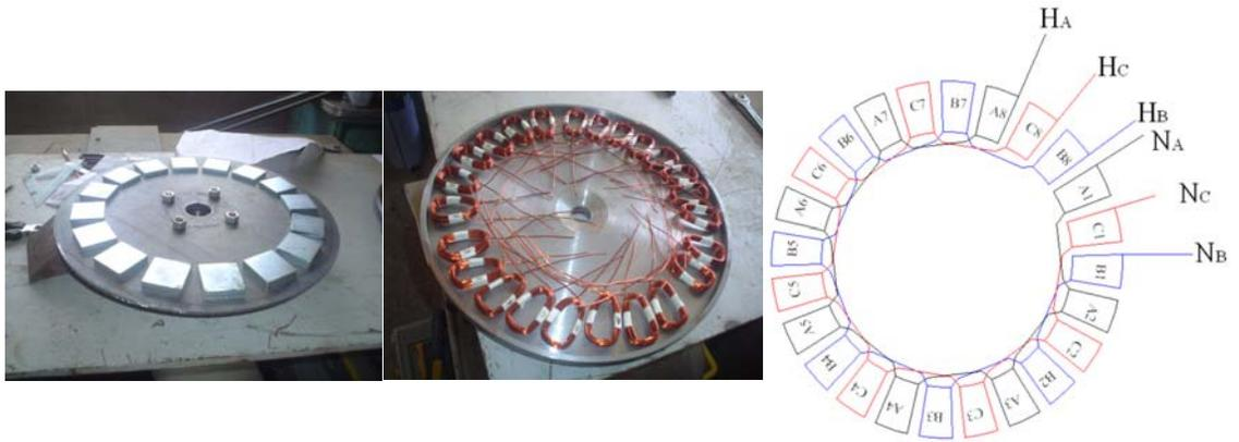
**Figura 5.5.** Distribución de los imanes en un disco - distribución de las bobinas en el molde - forma de conexión de las bobinas
