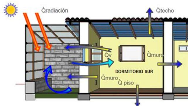
**Figura 66.** Ganancia y pérdidas de calor de dormitorio sur con ventana este abierta.
