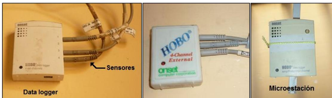
**Figura 33.** Adquisidor de datos Hobo U12-006 y H08-006-04 y U12-012.
