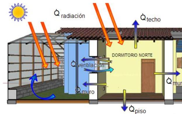
**Figura 65.** Ganancia y pérdidas de calor del dormitorio norte con ventana este abierta.
