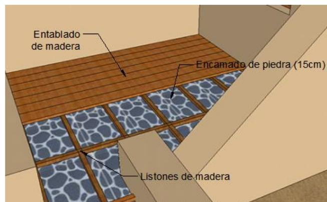
**Figura 22.** Esquema ilustrativo de aislamiento higrotérmico de pisos.
