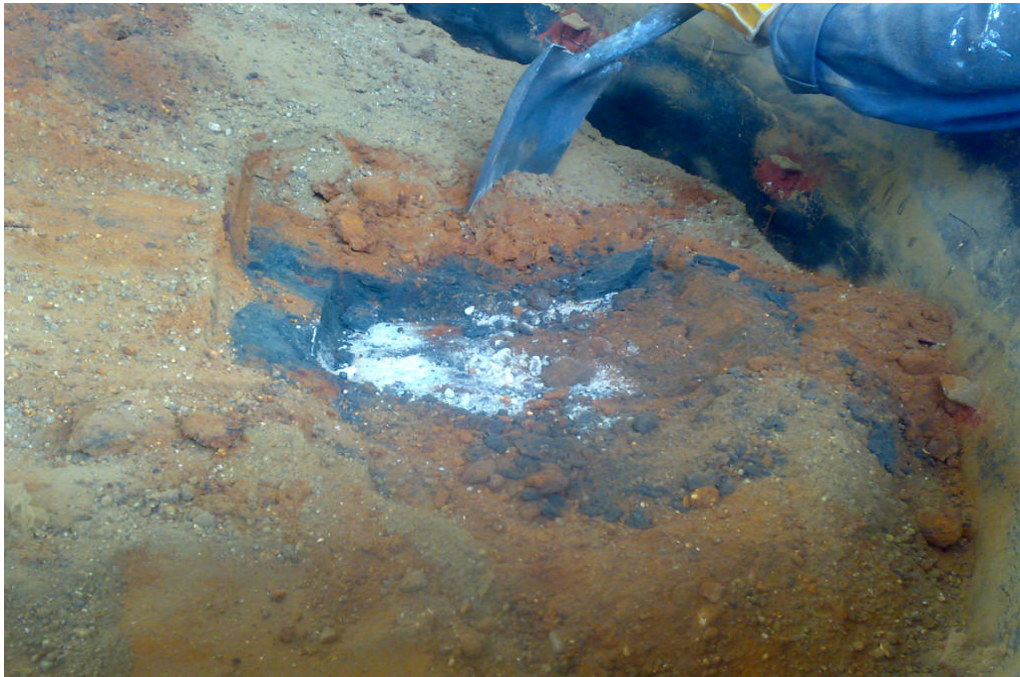
TIERRA FILTRANTE EN LOS PURIFICADORES DE ACETILENO
