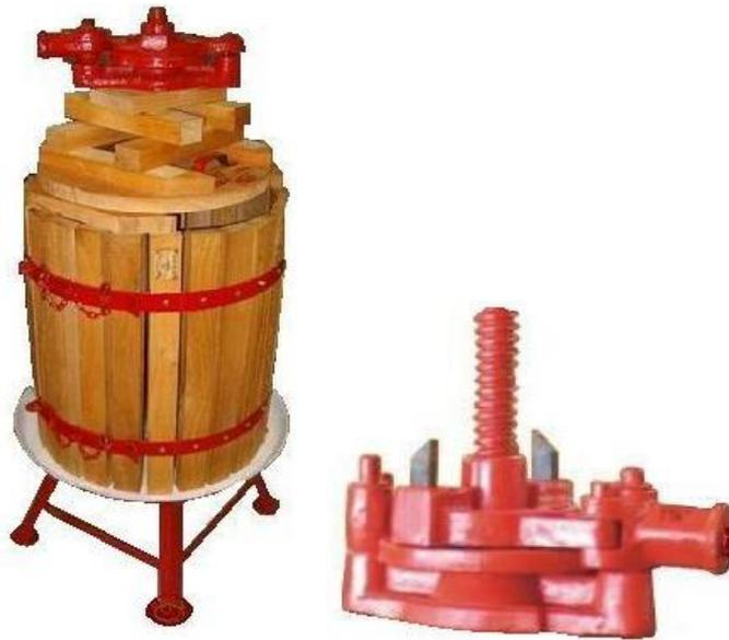
Figura 3.4.- Prensas Palanca - Modelo MARMOLIER
