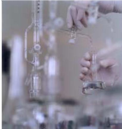
Figura 4.1.- Prueba de determinación del grado alcohólico.
