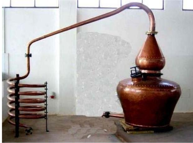
Figura 3.7.- Vista de un alambique de cobre antes de ser instalado
