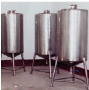
Figura 1.3.- Fermentadores Unitanque
