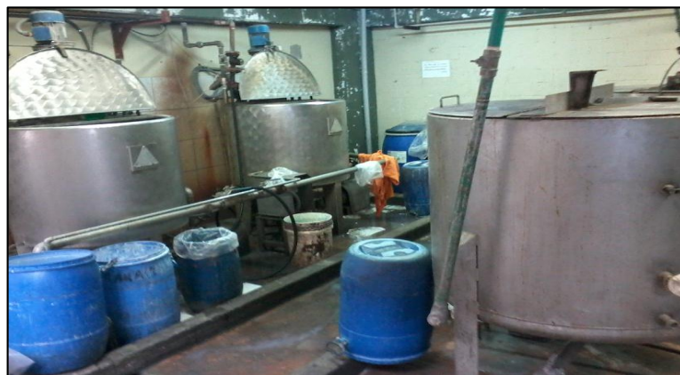
Figura 29. Ollas para el preparado del baño de acabado
