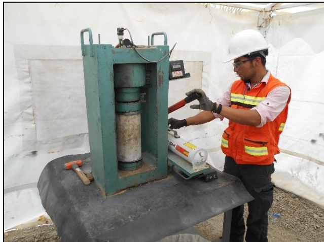
Fotografía 4-1: Ensayo de resistencia a la compresión de cilindros de concreto.
