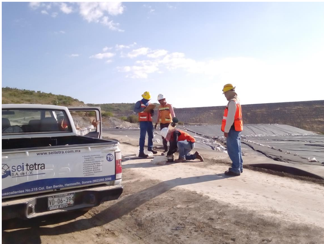
Foto N° 9: Pruebas de densidad en campo mediante el método del cono de arena.
