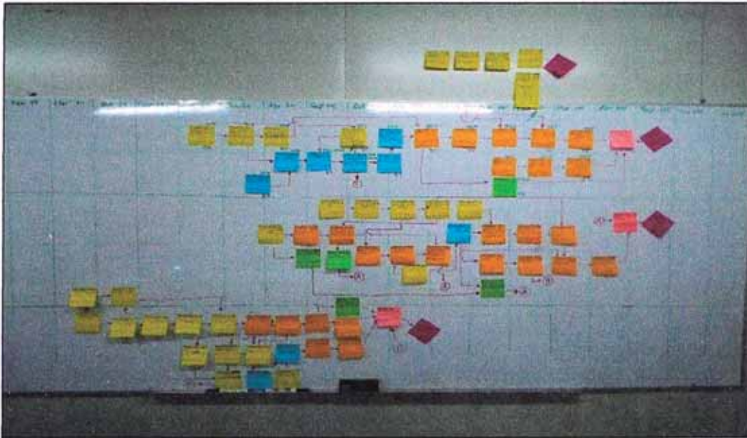
Figura N° 09: Diagrama de red - Proyecto Cerro Verde 2 Fase 1 K171 (Fuente: Equipo Implementador – CGP)
