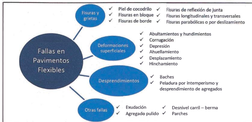
Figura 1.21. Fallas en pavimentos flexibles.
