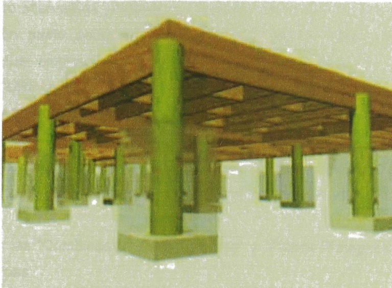
Figura N° 02: Esquema de uso de pilotes impermeabilizados
