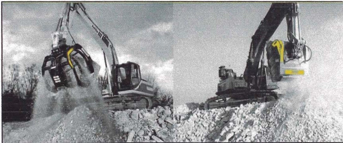
Figura N° 2.7: Método alternativo de producción de material para rellenos in-situ. Fuente: Presentación de aditamentos MB S.p.A. The crushing evolution
