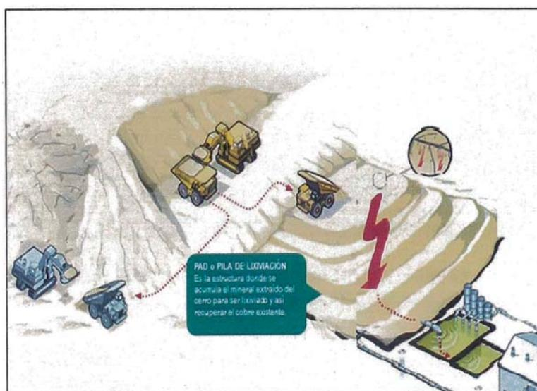
**Figura N° 02.- Pila de Lixiviación (Proceso del ROM).**
