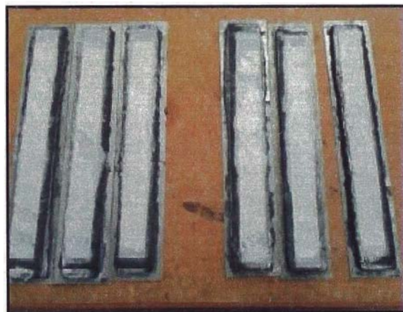
Figura 3.21 – Muestras al término del ensayo LWT (ISSA)
