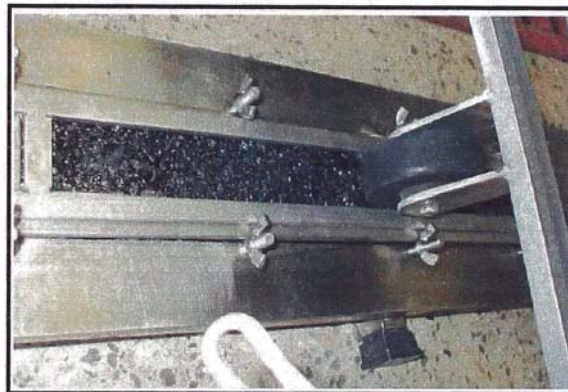
Figura 3.19 – Muestra colocada en la máquina Ensayo LWT (ISSA)
