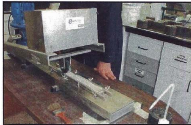
Figura 3.20 – Aplicación de arena Ensayo LWT (ISSA)
