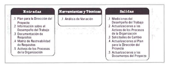
Figura N° 2.15 Proceso de control del alcance.
