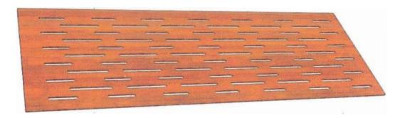
La Plancha de MDF perforada de 12mm (Enchape pumaquiro o similar), se ubicaran en la parte superior del muro de fondo (placa absorbente), Ver gráfico.
