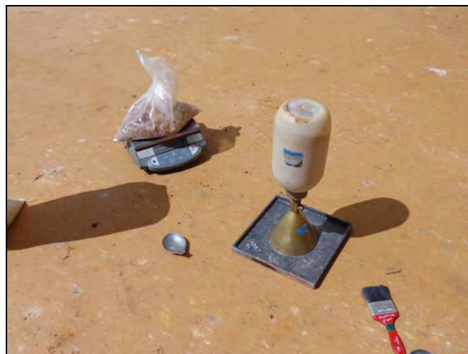
Fotografía N° 10 – Ensayo in situ usando el cono de arena
