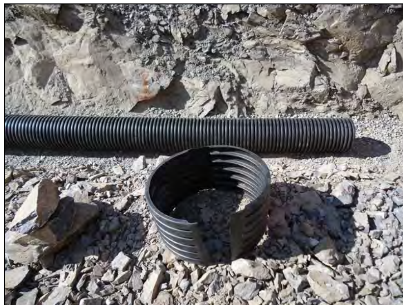
Fotografía N° 4: Uniones de HDPE según el tamaño de la tubería
