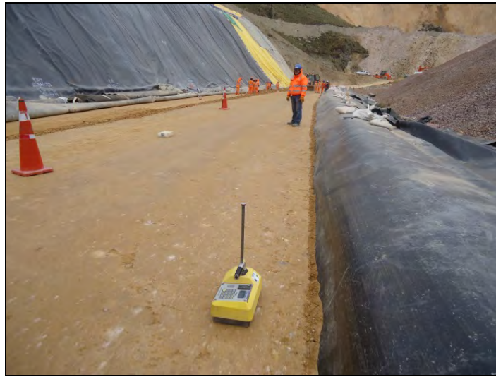
Fotografía N° 11 – Ensayo en campo usando el densímetro nuclear
