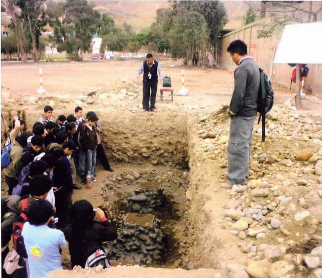
FOTO N° 2.2 Corte directo “In Situ” UNI.
