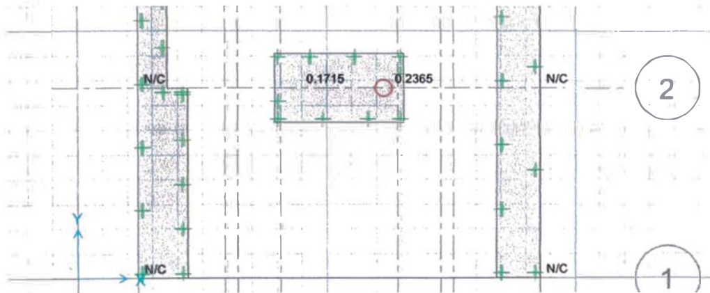
Figura N° 5.21: Relación de punzonamiento en la zapata Z-3
