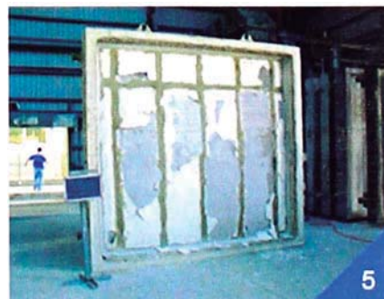
Figuras 2.21: Secuencia y resultados luego de someter el pórtico a 1000 grados Celsius
