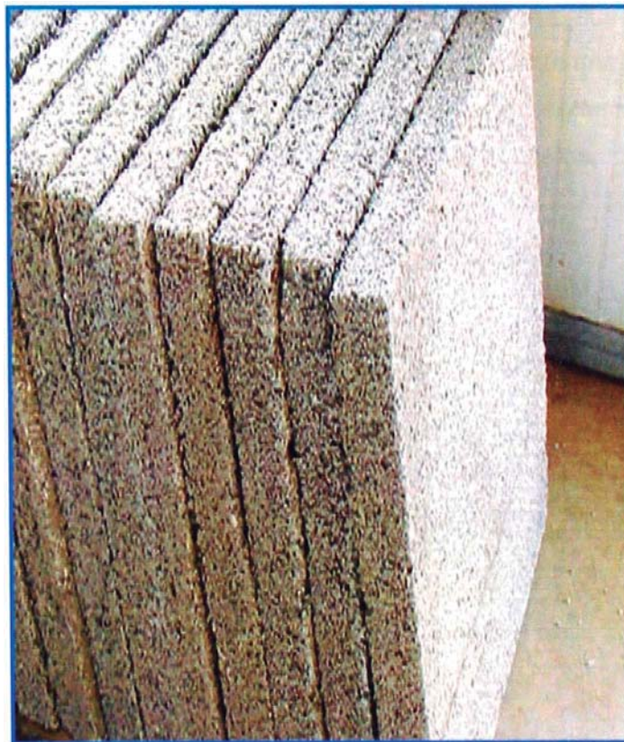
Figura 1.8: Panel prefabricado de hormigón liviano
