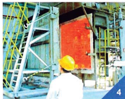
Figuras 2.21: Secuencia y resultados luego de someter el pórtico a 1000 grados Celsius
