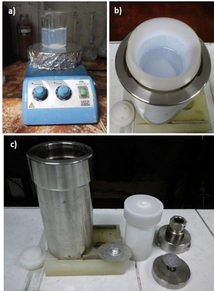
Figura 3.2. Síntesis de nanopartículas de \text{TiO}_2 por sol-gel. a) obtención del gel. b) nanopulvos de \text{TiO}_2 luego del tratamiento hidrotérmico. c) componentes del sistema de autoclavado.
