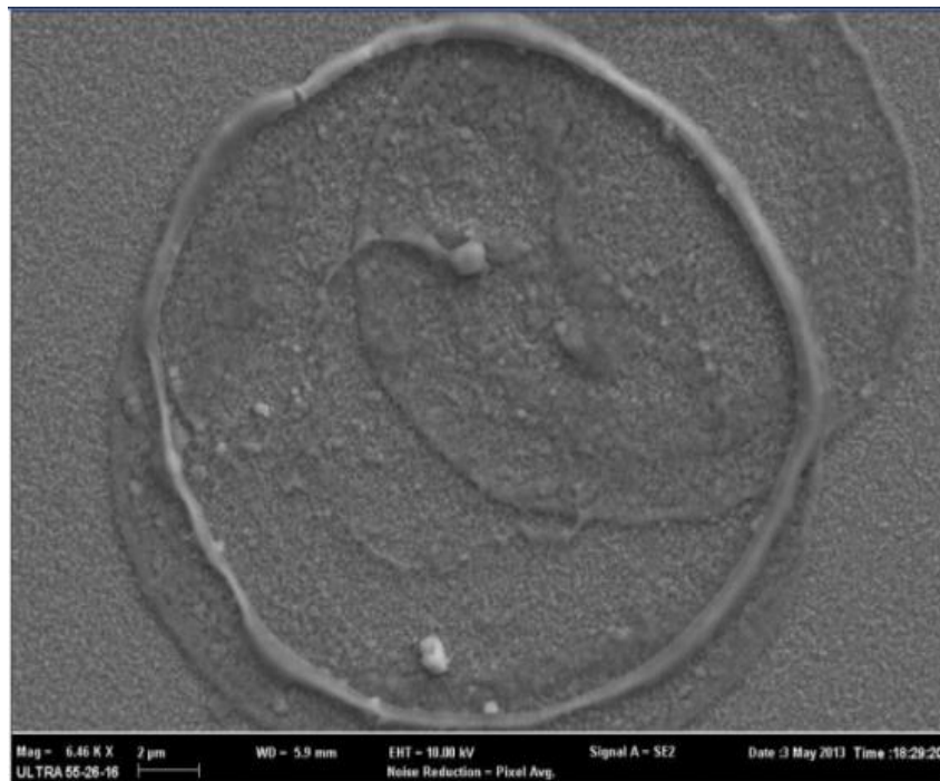
Figura 10. Micrografía de la superficie para de la capa de bloqueo de 104.2 nm de espesor de la capa de bloqueo. Escala 2\mu m . [47]
