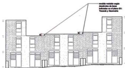
Ejemplo de elevación para terrenos en desnivel
