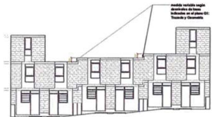
Ejemplo de elevación para terrenos en desnivel
