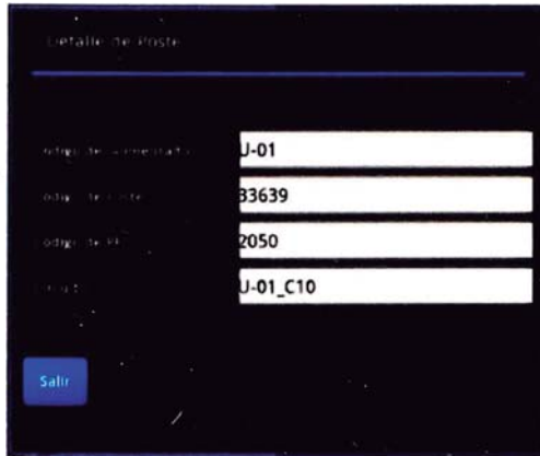
Figura 30: Vista de detalle de atributos del Poste de MT(Media Tensión) - Fuente Empresa
